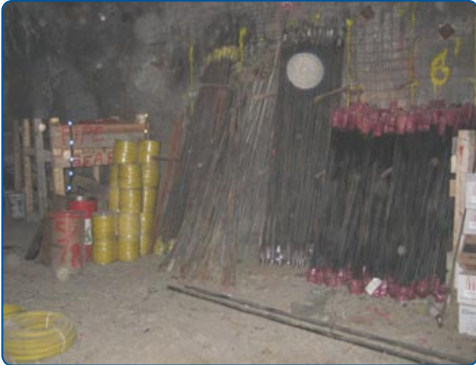
Figure 1 : Boulons utilisés pour le soutènement
