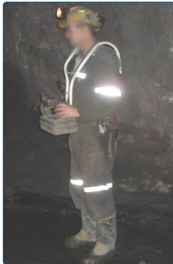
Figure 3 : Utilisation à distance de la benne à godet.
