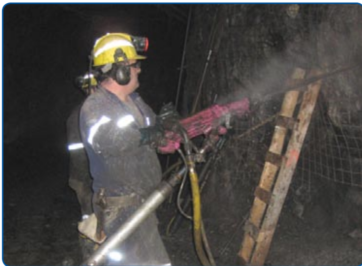
Figure 3 : Utilisation d'une foreuse sur béquille
