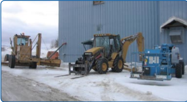
Figure 1 : Niveleuse, pelle rétrocaveuse, nacelle élévatrice
